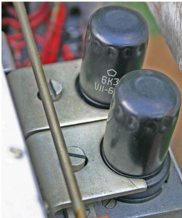
Die Röhren des zweiten Oszillators und der zweiten Mischstufe sind durch zusätzlich angeschraubte Krallen gesichert.
