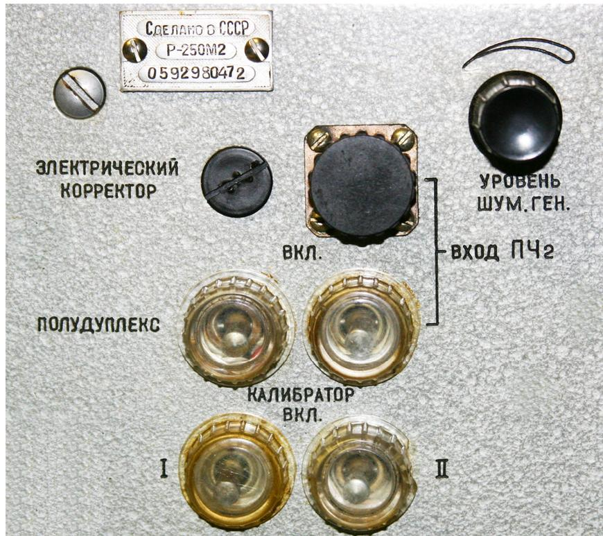
Der Quarzeichgeber wird über Kippschalter I und II bedient. Darüber befinden sich links der Schalter für Halbduplexbetrieb und rechts der Schalter zur Aufnahme der 2.ZF 215 kHz über die darüber liegende Koax-Buchse. Hinter der Plastschlitzschraube befindet sich die Korrekturmöglichkeit für den 2. Oszillator. Ganz rechts liegt der Regler des Rauschgenerators.
