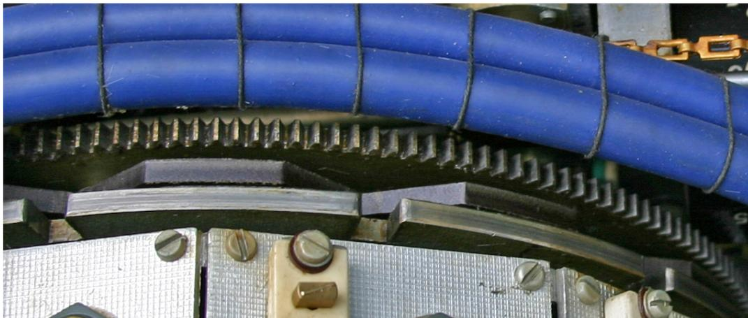
Ein großes Zahnrad und gefräste Schalt-Scheiben sorgen für die korrekte Bewegung des Spulenrevolvers.
