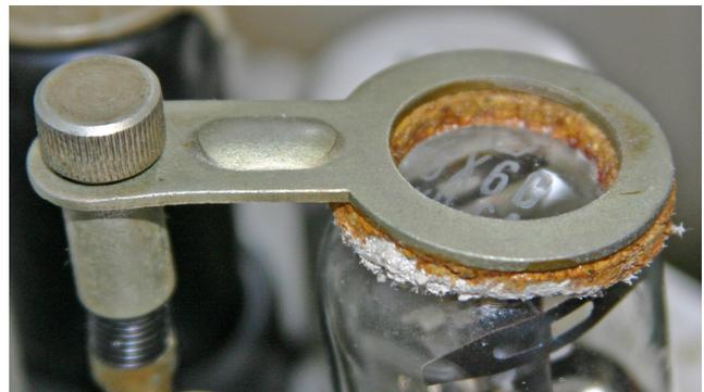
Alle anderen Röhren sind in dieser Form gesichert, die Glasröhren mit einer Asbestscheibe gegen Platzen.
