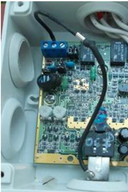
Die Schutz Erde des Verstärkers ist mit der FTP-Abschirmung in der Verstärkerbox verbunden (Abb. 20). Für das FTP-Kabel jedes Verstärkers werden Gleichtaktdrosseln [20] verwendet (Abb. 18). Die FTP-Abschirmung zwischen der Drossel und der Antenne ist an einem in den Boden eingeführten Kupferstab geerdet.
