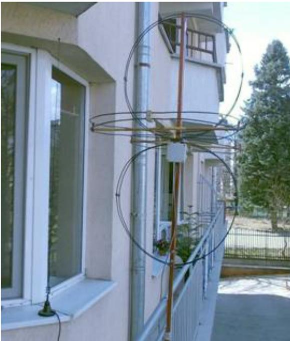
Abb. 7. Aufbau mit doppelter Polarisation mit einem einzelnen AAA-1-Verstärker. Beide CC-Schleifen sind identisch, nur die Platzierung ist zueinander orthogonal. Die horizontale Schleife hat reine HP, die vertikale Schleife hat eine gemischte Polarisation, aber eine reine VP in der Richtung senkrecht zur Gebäudefläche.
