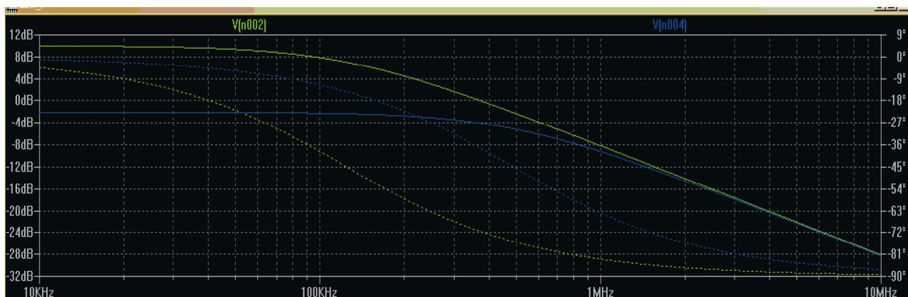
Abb. 6. Frequenzgang des Schleifenstroms in einen Lastwiderstand von 6 Ohm. Die grüne Linie ist für eine einzelne 8-Zoll-Schleife und die blaue für eine CC-Schleife.
