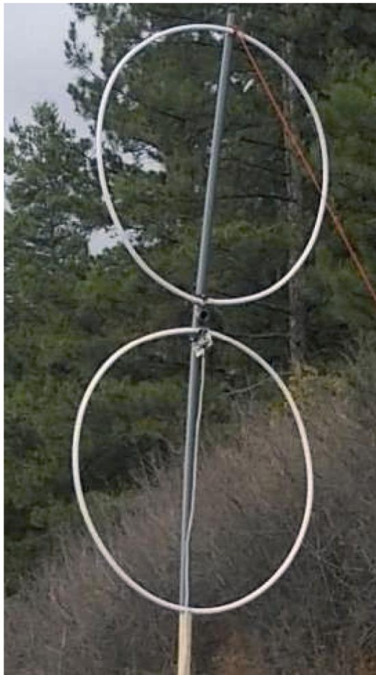
Abb. 5. Schleife 5: 2 x CC-Schleifen mit 0,96 m  $\varnothing$ . Loop ist aus PE/Aluminiumrohr mit 15 mm  $\varnothing$ .
