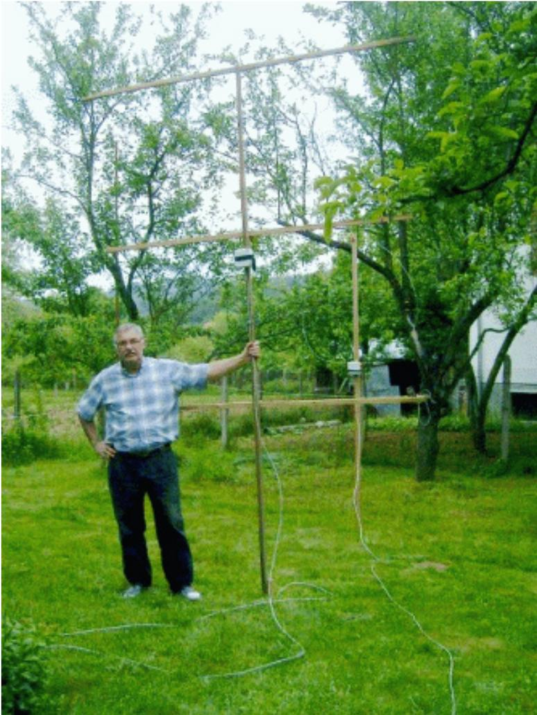
Abb. 5. Der Autor auf der experimentellen grünen Wiese. 4 m<sup>2</sup> 4-Quadrate gekreuzte Parallelschleife sind auf einem Holzrahmen montiert.
