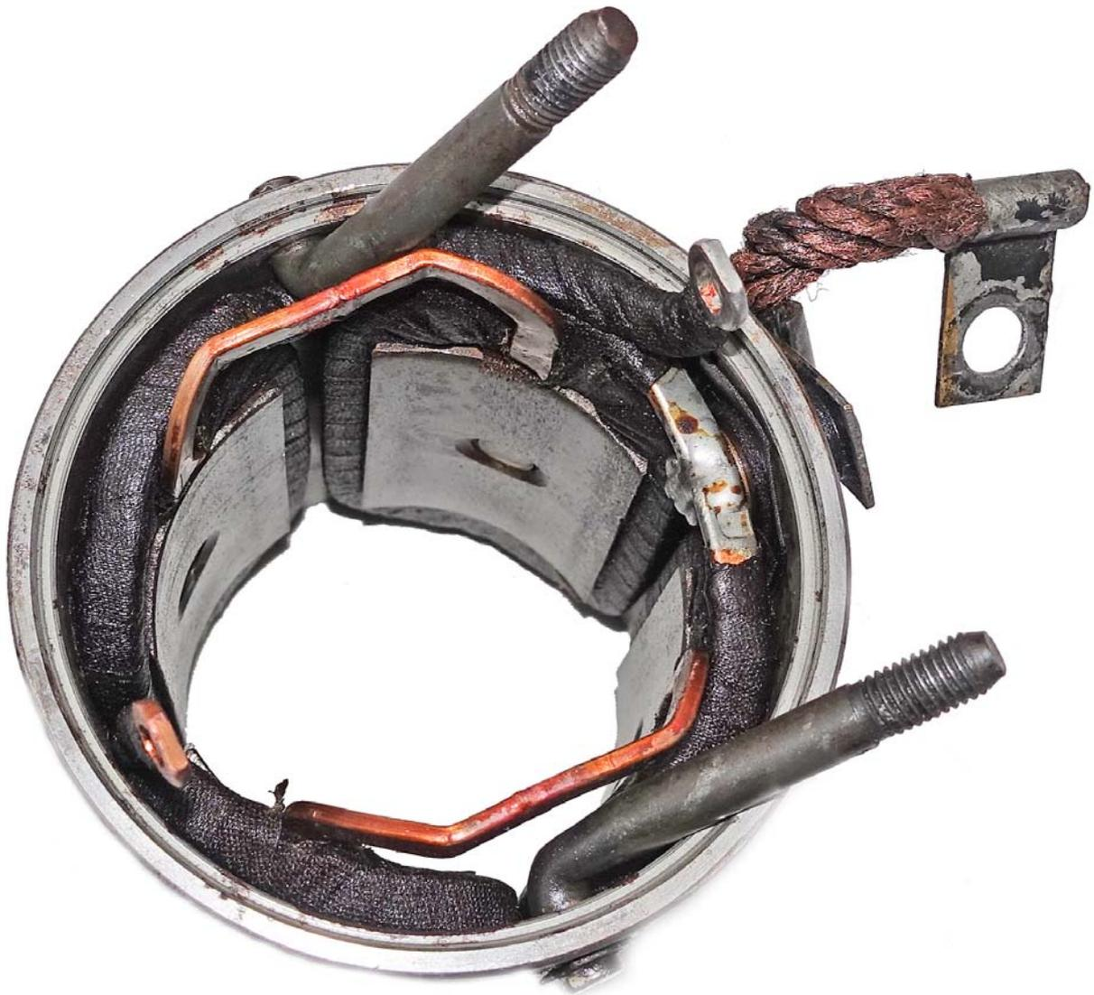
Bild oben: Polgehäuse des Hakenbolzenanlassers (6 V – Ausführung). Alle 4 Pole werden vom Hauptstrom durchflossen. Deutlich sichtbar auch, daß für innen liegende Stehbolzen bzw. Langschrauben, die vorderes und hinteres Lagerschild mit dem Polgehäuse verschrauben würden, kein Platz ist.
