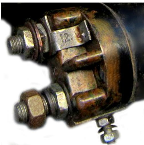
Bei dem nachfolgenden Magnetschalter in runder Bauform saßen die Spulen fest und die Kappe ließ sich zum Reinigen der Kontakte über 2 Schrauben lösen und auslöten.
