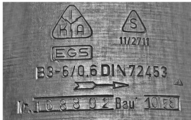
Typenschild des 12 V 1 PS Anlassers für Barkas B1000 und Garant 30K (Bild links). Der gleiche Anlasser wurde auch in 6 V 0,6 PS für Wartburg (Bild rechts) bzw. mit umgekehrter Drehrichtung für den Trabant gebaut.
