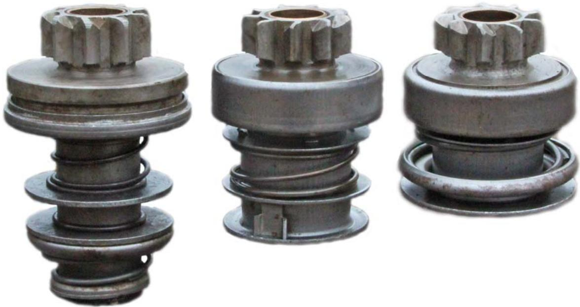
Die Ritzelfreilauf Typen der DDR-Pkw-Anlasser: Links der alte, unverwüsthliche Bosch-Typ, rechts der neu entwickelte Ritzelfreilauf für die 4. Anlassergeneration. In der Bildmitte der Ersatztyp für den Bosch-Ritzelfreilauf als Ersatzteillieferung der vorigen Anlassergenerationen, gefertigt nach neuer Technologie. Die Lebensdauer des Bosch-Ritzelfreilaufs wurde nicht mehr erreicht. Deutlich sichtbar sind die Materialeinsparungen, die letztlich zu Qualitätseinbußen führten.
