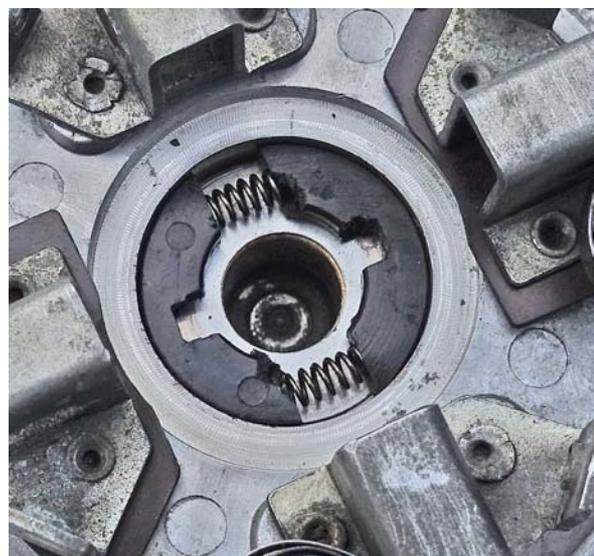
Mechanische Bremsanlage im Bosch-Anlasser. Ein Zylinderstift, der quer zur Ankerwelle sitzt, nimmt die beiden Bakelitbremsbacken im Kollektorschildlager mit.
