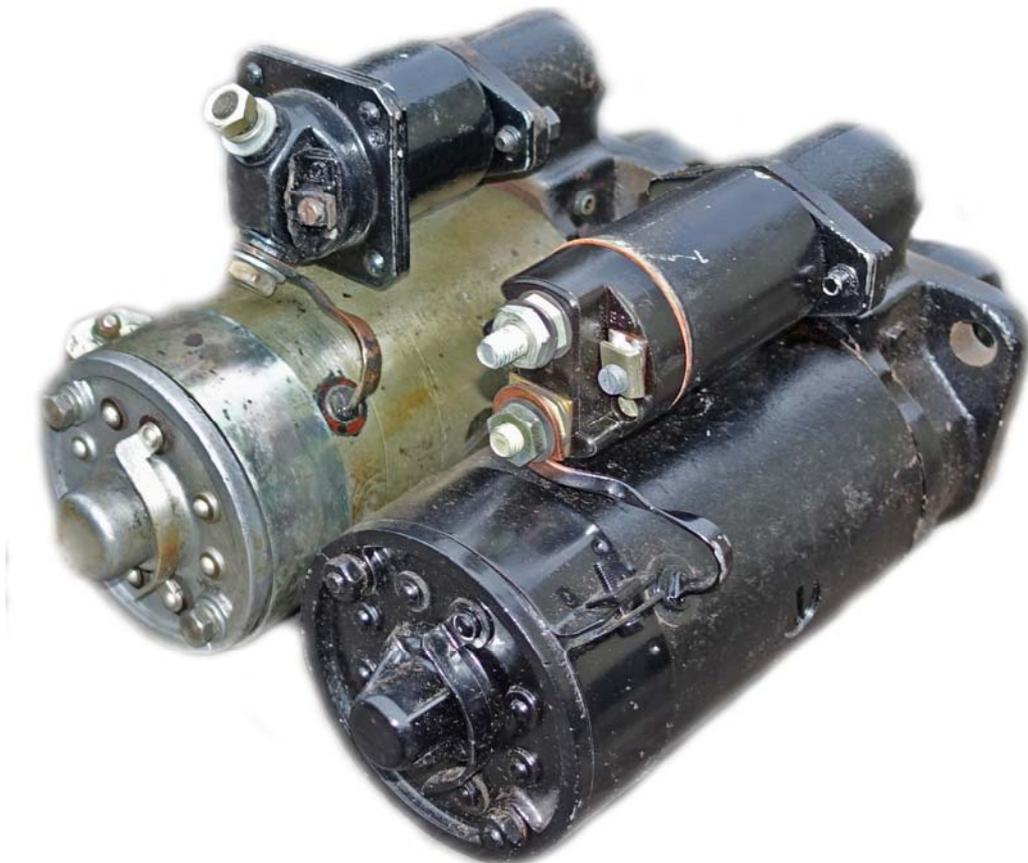
Der Nachfolgetyp des Bosch-Magnetschalters (vorderer Anlasser). Dieser kam auch am 12 V 1,8 PS - und 12 V 3 PS – Anlasser zum Einsatz. Für den 24 V 4 PS – Anlasser (IM 11) erfolgte keine Neuentwicklung, weil man diesen Schubschraubtrieb-Anlasser durch den Schubankeranlasser IM 17/18 ersetzte.
