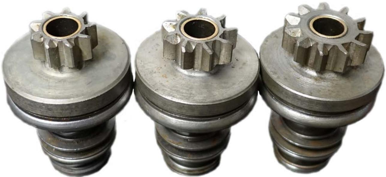
Ritzelfreilauf der 12 V 1,8 PS bzw. 3 PS-Anlassertypen: Links das 9 Zähne-Pkw-Modul für Garant 30K, Wartburg und Multicar M21. In der Mitte das 9 Zähne-Modul für Robur LO und rechts das 11 Zähne-Modul für diverse Dieselmotoren. Die beiden 9-Zähne-Ritzel unterscheiden sich nur in einer feinen und groben Verzahnung.
