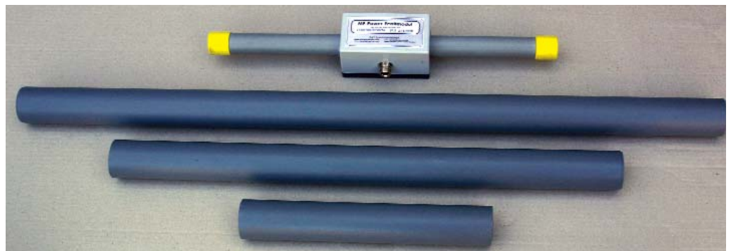
Bild 7: Der KW-, MW- und Längswellenferritstab (von unten nach oben) im Vergleich zum MW-Ferritmodul von BAZ.
